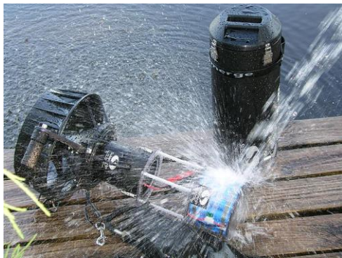
N-19 modellen har kapslade battericeller, vilket gör den vattentät även inuti
